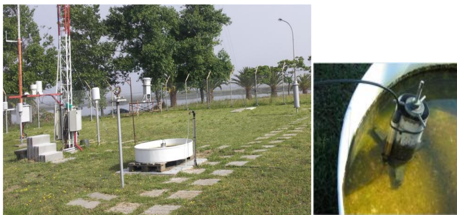
Infraestruturas e Sensor da evaporação da Tina da Classe A
