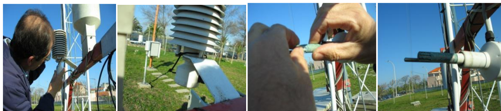
Figura 3 – Abrigo de radiação e detalhes da limpeza do sensor de Temperatura e húmida da 4ª semana de cada mês.
