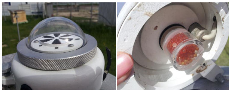
Figura 6 – a) Procedimento para retirar o reservatório de sílica gel do piranómetro; b) Reservatório de sílica gel do piranómetro
