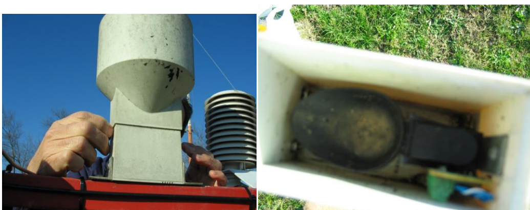
Figura 7 – a) Udómetro Figura; b) – Interior do udómetro
