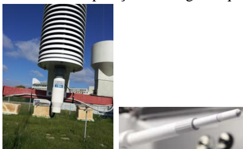
Termómetro Vaisala HMP155 com escudo de radiação:
