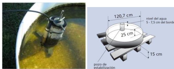
Figura 8 – Detalhes del sensor de evaporação Tina classe A
